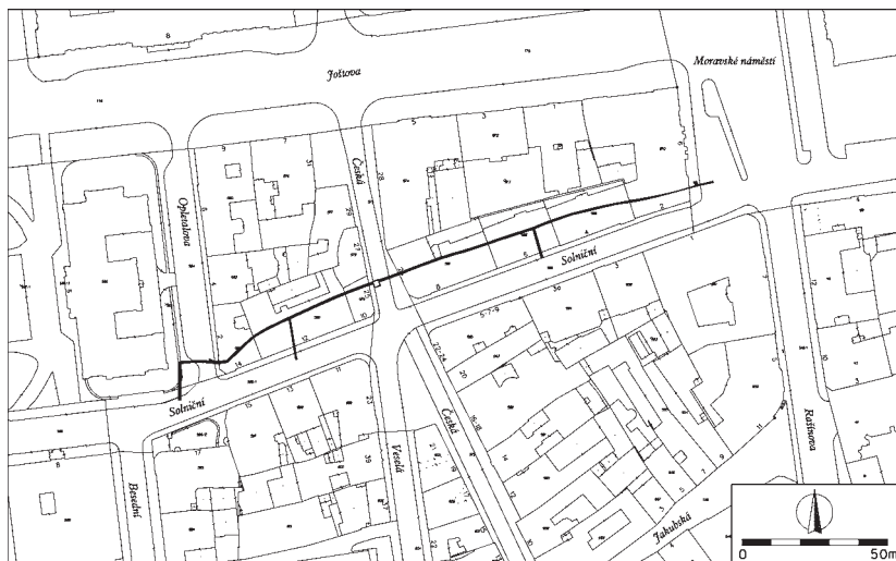
Obr. 12. Česká (A076/2006). Vyznačena je sonda a průběh prozkoumané hlavní trasy kanalizace a jejích přípojek. Česká-Str. (A076/2006). Suchschnitt und Verlauf der untersuchten Haupttrasse der Kanalisation und ihrer Anschlüsse.
