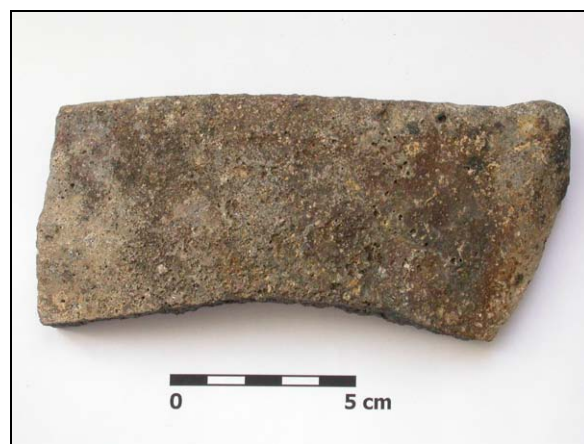
Obr. 2 Stěna tyglíku (Brno NS 2) se zelenými krustami obsahující Ag, Cu
